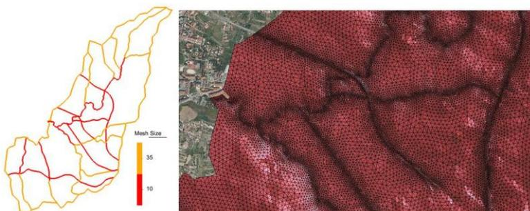
**Figura 5.** Tamaños de elemento de la malla de cálculo (izquierda) y detalle de la malla en las proximidades del cierre de la cuenca (derecha).
