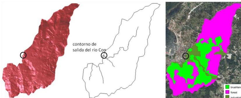
**Figura 1.** Modelo hidrológico distribuido de la cuenca del río Con. MDT (izquierda), principales corrientes de agua superficiales (centro) y usos del suelo (derecha). El círculo negro indica la situación de la sección de aforo en el río Con.
