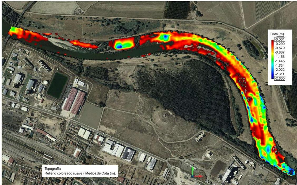
Figura 4 | Mapa de erosión (diferencia negativa entre batimetrías).
