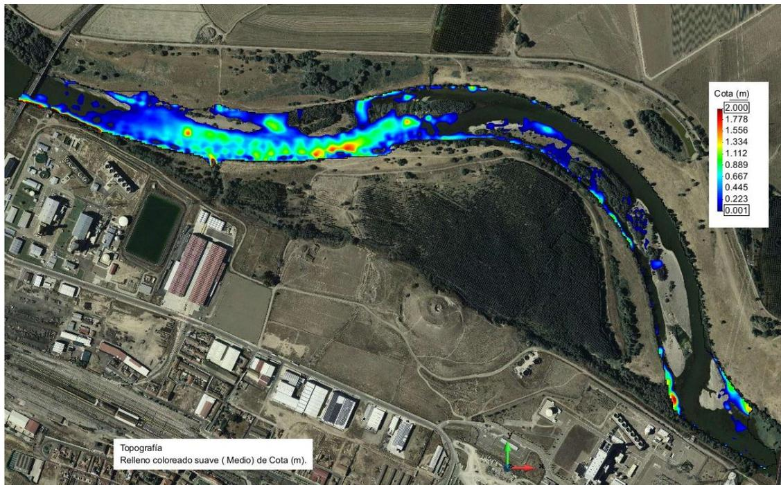
Figura 5 | Mapa de sedimentación (diferencia positiva entre batimetrías).
